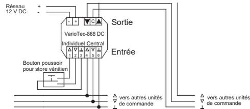
Fig. 4 Connexion comme appareil de commande de groupes
