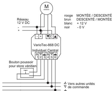
Fig. 3 Connexion comme appareil de commande d'entraînement
